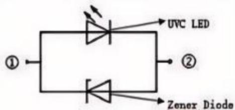
齐纳二极管仅用于提供 ESD 防护，以免 UVC LED 芯片遭受静电击穿。同时，我们致力于提高 UVC LED 芯片自身的抗静电能力，直至无需齐纳二极管防护。若此种结构发生变更，恕不另行通知。
